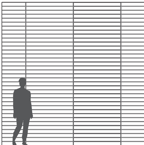
Troldtekt v-line 2way 6 monteret i vandret rudeforbandt
